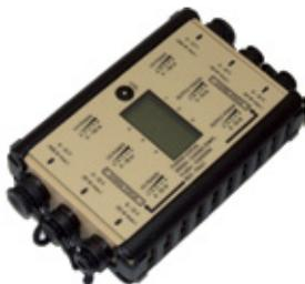
Dieses intelligente Gerät ist Teil der portablen Stromversorgungslösungen von SFC für Verteidigungsanwendungen. Es passt vollautomatisch Spannungen und Stromstärken der angeschlossenen Geräte und Stromquellen aneinander an. Besonders praktisch: der Benutzer kann sich das Mitführen vieler unterschiedlicher Batterietypen und damit entscheidend Gewicht sparen – eine einzige Stromquelle, z. B. die Jenny-Brennstoffzelle, deckt so die Spannungsanforderungen der unterschiedlichsten Geräte ab.
